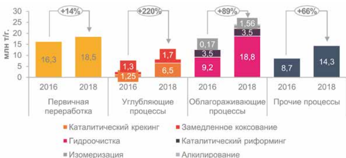
Рис. 2 Изменение мощностей установок первичной и вторичной переработки нефти на 3-х крупнейших НПЗ РК по результатам их модернизации Источник: ИГ "Петромаркет"
